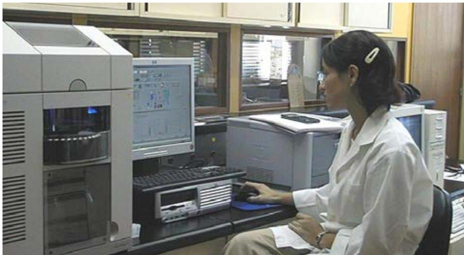
Equipos de laboratorio instalados y en operación: electroforesis capilar.
