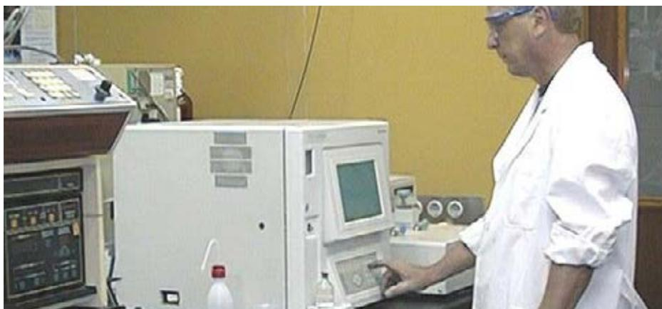
Equipos de laboratorio instalados y en operación: analizador de carbono total.
