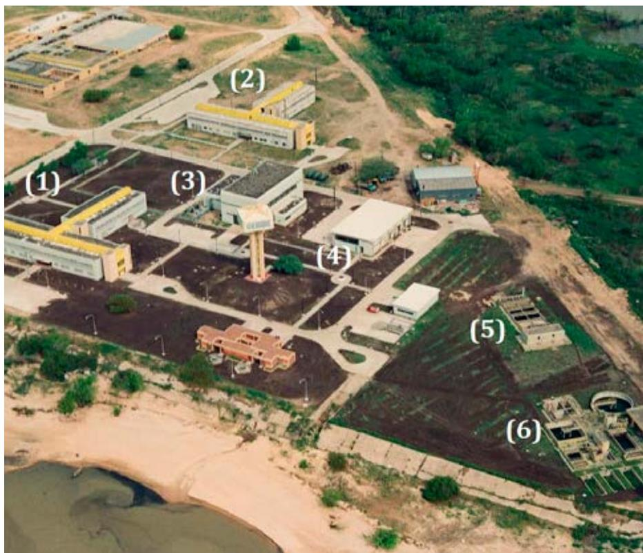
Predio con terreno refulado y las instalaciones del INTEC construidas: (1) Edificio INTEC I, (2) Edificio INTEC II, (3) Planta Piloto, (4) Edificio Talleres, (5) Planta potabilizadora de agua, (6) Planta de tratamiento de líquidos residuales.
