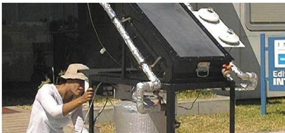
Reactor solar diseñado y construido en el INTEC, operando en el exterior del edificio.
