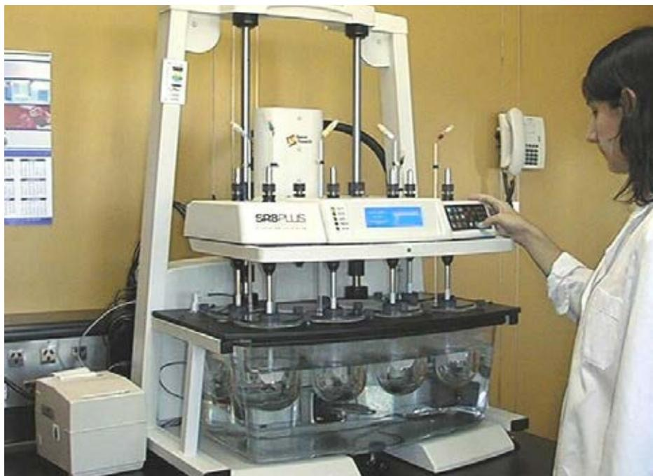
Equipos de laboratorio instalados y en operación: disolutor de muestras.
